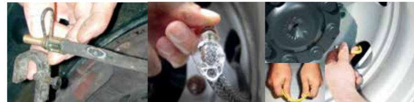
Extensiones convencionales contienen la presión entera en la cámara de la extensión. Daño a la extensión a través de uso o accidente puede significar la pérdida de aire en la llanta.
